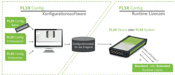
Die Konfigurationssoftware am PC (z.B. FL3X Config Basic) generiert eine Konfigurationsdatei für das Endgerät.
