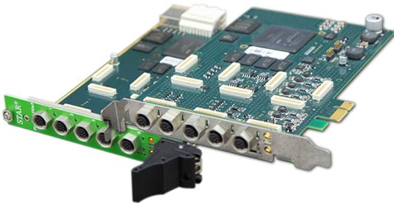
BU: FlexCard PCIe3 und FlexCard PXIe3 – BEWÄHRTES NEU INTERPRETIERT – das FlexDevice hält Einzug in die Messumgebung
